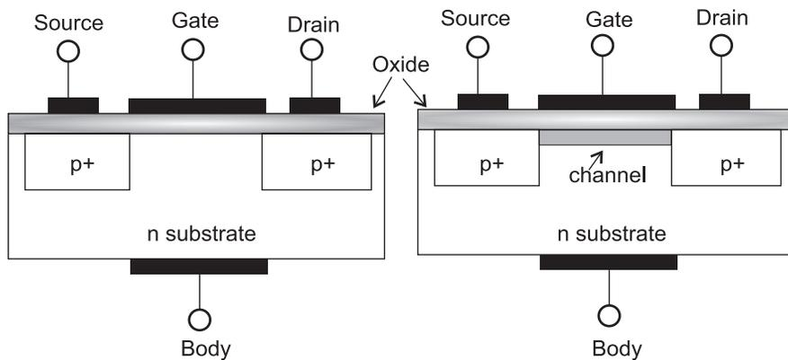
**Figure 1.5:** (c) Enhancement P-type MOSFET (d) Depletion P-type MOSFET
